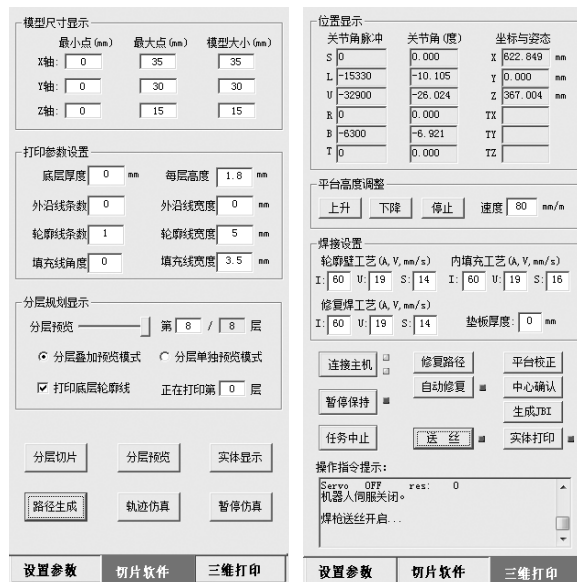
图 3 综合控制平台软件功能模块界面
